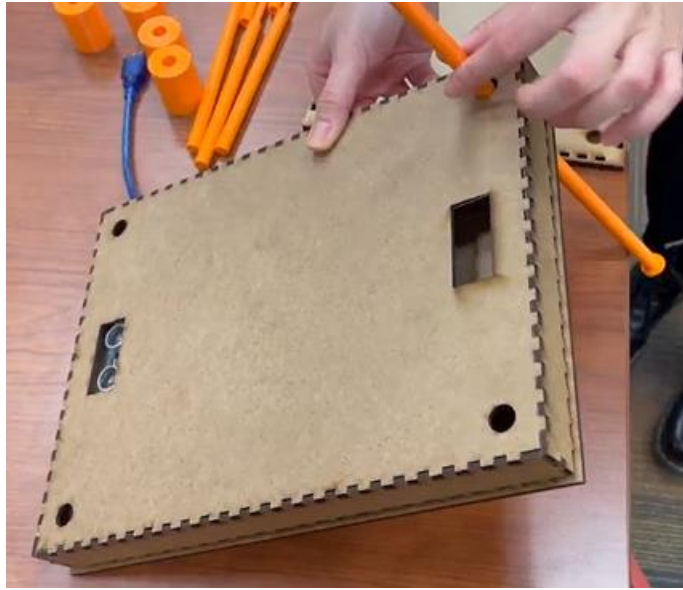
Figure 2.4 : Assemblage des barres de support et de la boîte de MDF
