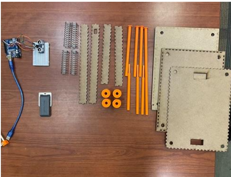
Figure 2.0: L'équipement pour l'appareil de mesure des forces
