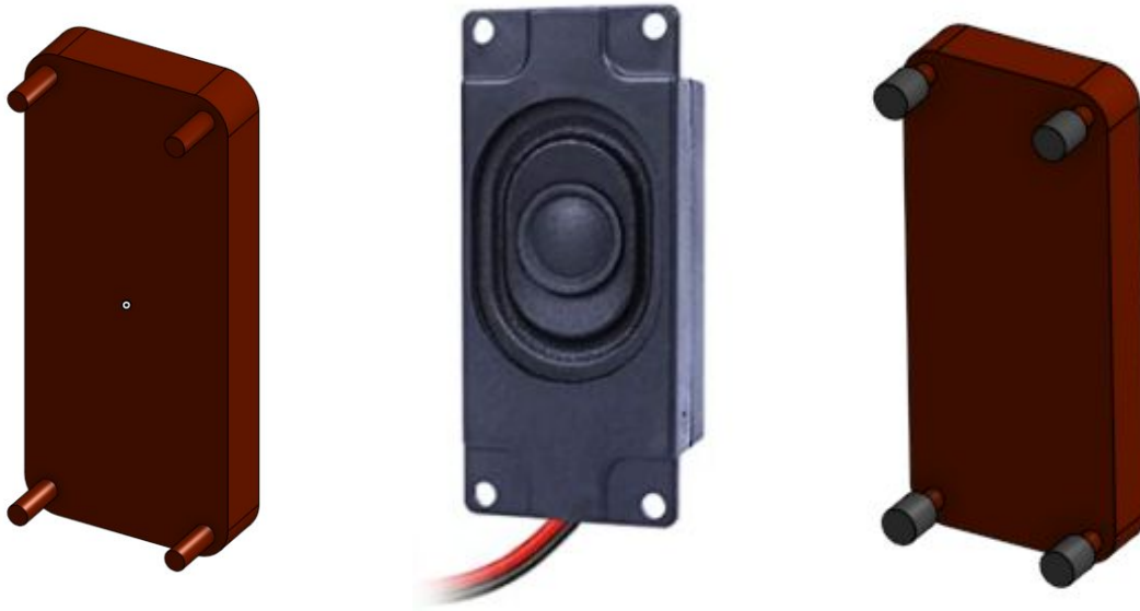
Figure 6 : Fixation murale pour le haut parleur - Vue isométrique
