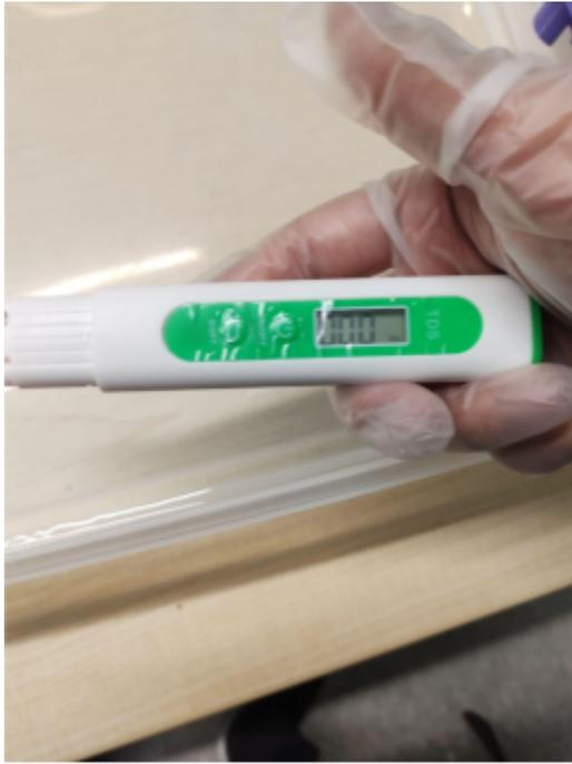
*Figure 5 : TDS mètre allumé et calibré avant de faire une mesure*
