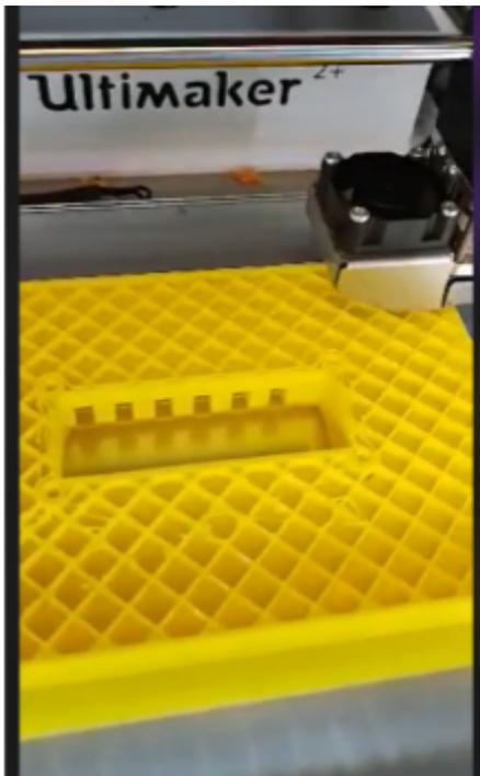
*Figure 7 : impression 3D de la couvercle de la boîte*
