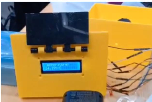
*Figure 16 : tests de l'écran LCD et le thermomètre*
