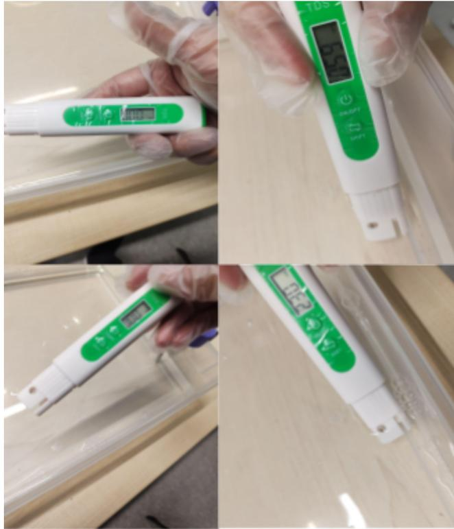
*Figure 15 : TDS mètre en fonctionnement. (de gauche a droit et de haut en bas) le capteur donne 0. Le capteur après donne 0.59 ppm avant l'ajout du chlore. Puis, 0 avant l'autre mesure et enfin une mesure de 2.30 ppm après l'ajout du chlore*
