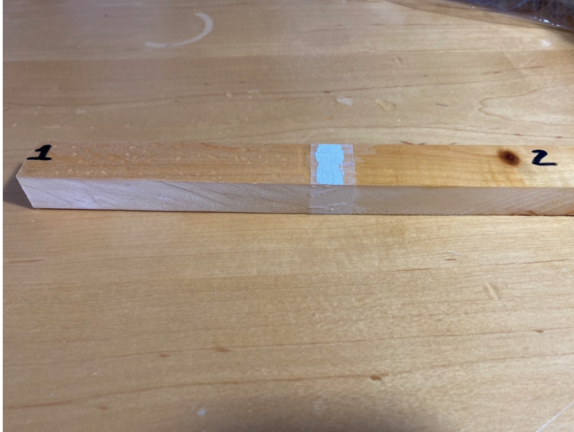
Fig 3 : Pièce de bois après être submergée dans l'eau
