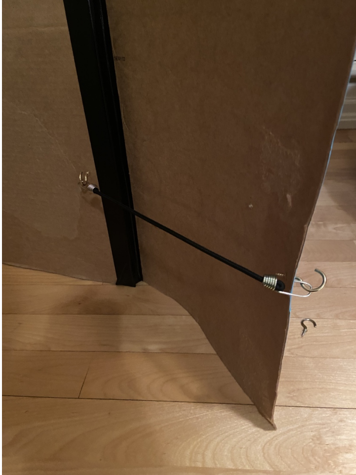
Figure 7 : Système d'ouverture potentiel avec corde élastique et crochets en métal
