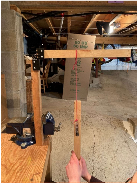
FIGURE 8 : TESTS DU BOITIER OUVERT EN APPLIQUANT 0, 5, 7.5, 10, 12.5 ET 15 LBS
