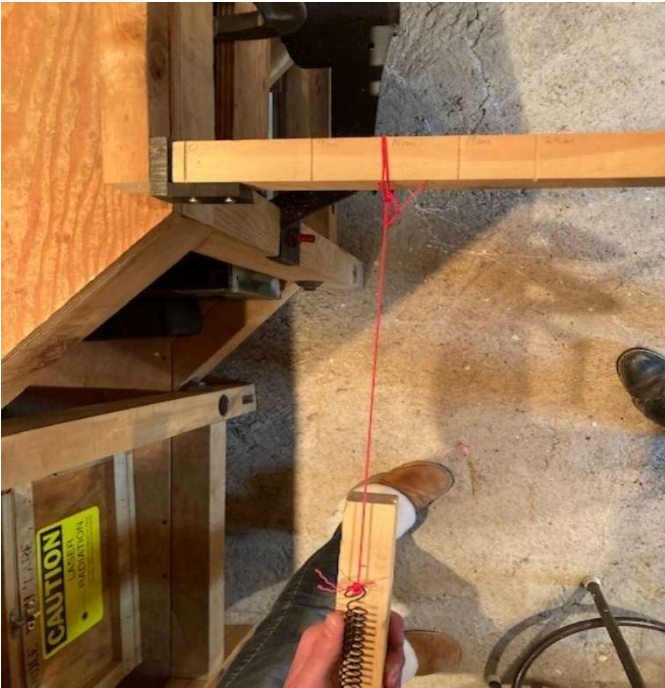
FIGURE 10 : TESTS DU REBORD AUQUEL SERONT FIXÉES LES ROUES, EN APPLIQUANT 10, 15 ET 20 LBS À 14 CM DU POINT D'APPLICATION DE LA FORCE
