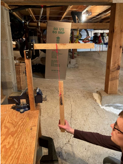
FIGURE 9 : TESTS DU BOITIER FERMÉ EN APPLIQUANT 0, 5, 7.5, 10, 12.5 ET 15 LBS
