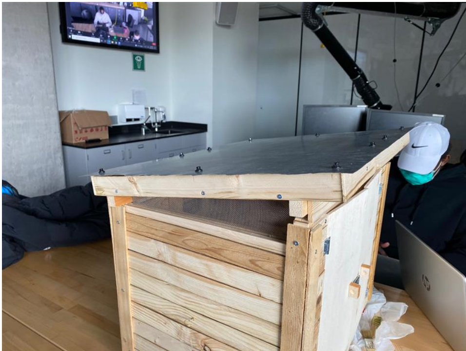
Fig 7: toit incliné métallique et moustiquaire
