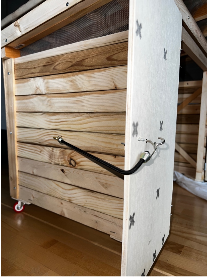
Fig 5: système pour garder les portes ouvertes
