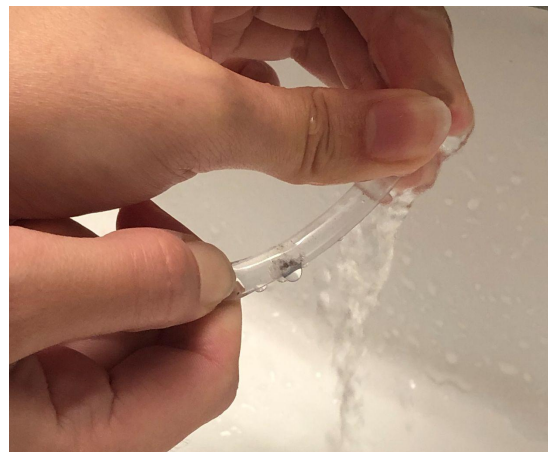
Figure 8 : Test 1 de régulation du flux d'eau avec trou
