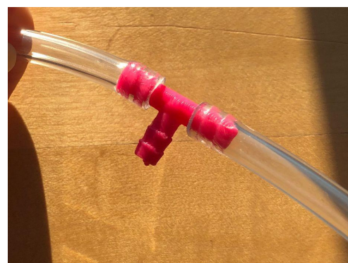
Figure 3 : test d'assemblage du tuyau avec les têtes d'arrosage
