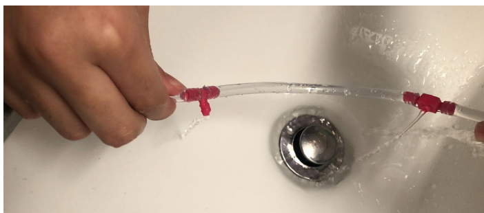
Figure 7 : test 1 de régulation du flux d'eau avec des embouts
