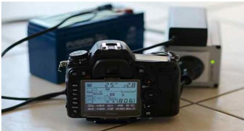
Figure 19: Alimentation d'une caméra à l'aide d'un courant continu externe<sup>2</sup>
