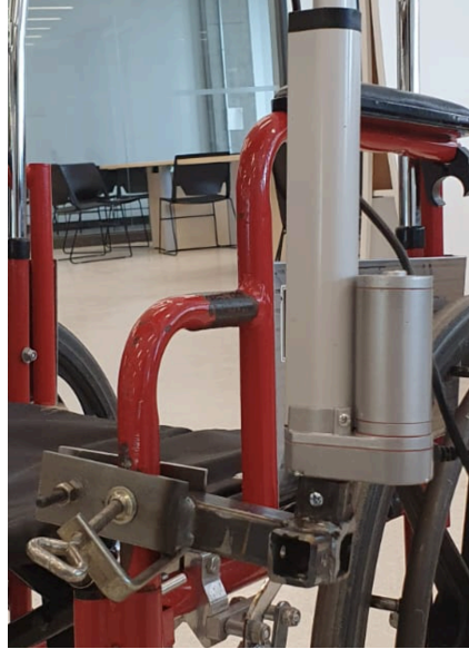
Figure 9-Fixation de l'actionneur linéaire sur la connexion métallique.
