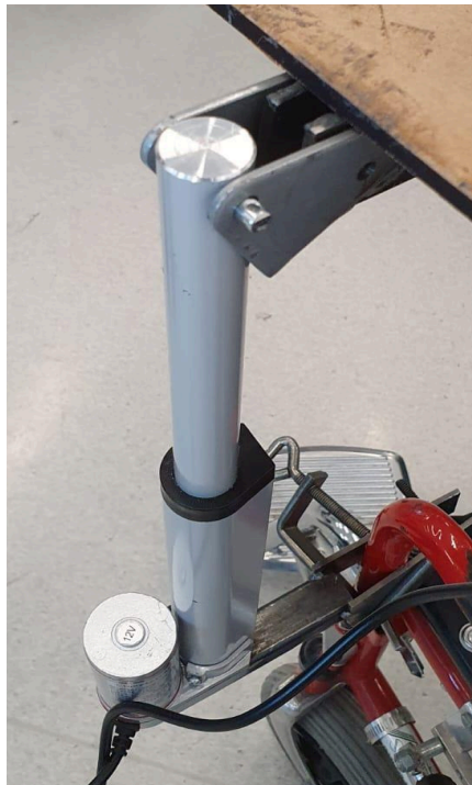
Figure 10-Connexion de la table à l'actionneur linéaire.
