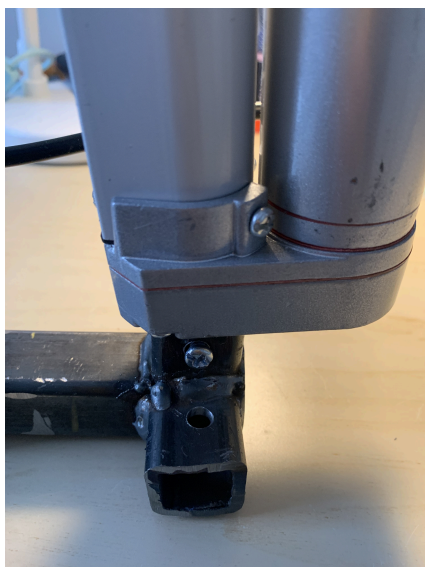
Figure 22-Assemblage entre l'actionneur linéaire et l'appareil de fixation
