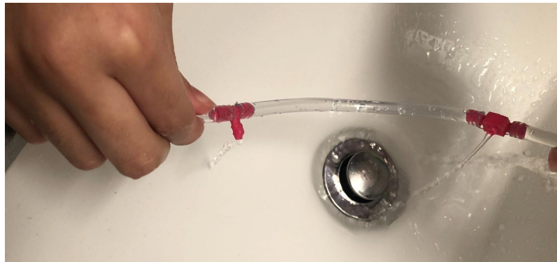
Figure 20 : Test de régulation du flux d'eau avec des embouts
