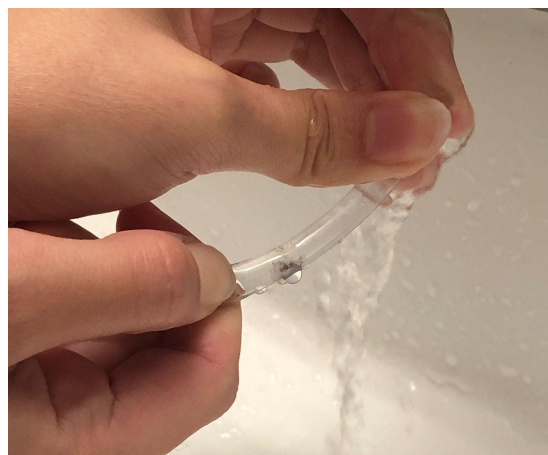
Figure 21 : Test de régulation du flux d'eau avec un trou
