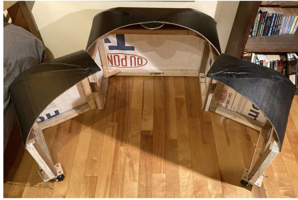
Figure 4. Cache-poubelle assemblé avec les portes (quarts) fixés à la partie arrière grâce aux charnières
