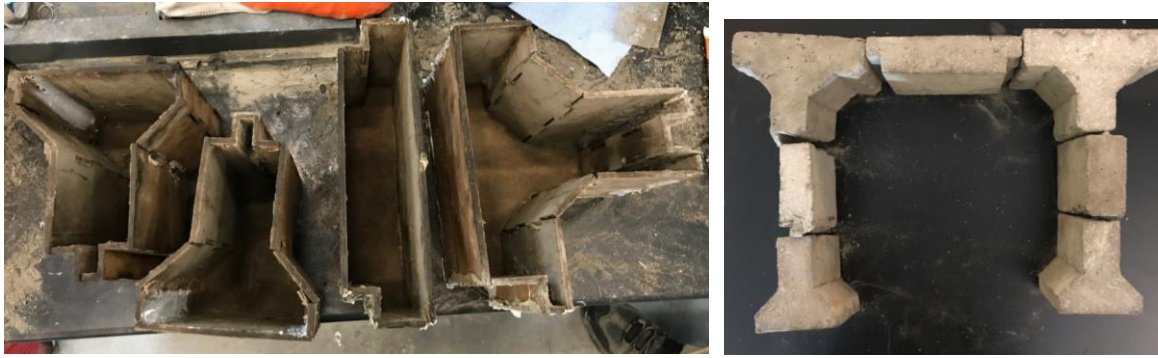
Figure 26 Les moules après décoffrage
