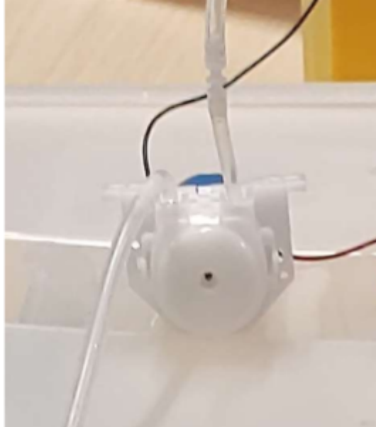
Figure 4 : pompe de chlore.
