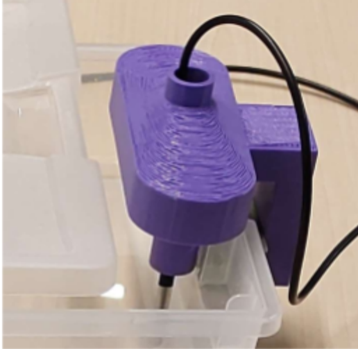
Figure 6 : exemple d'utilisation de la fiche de capteurs. Le thermomètre est toujours en contact avec l'eau
