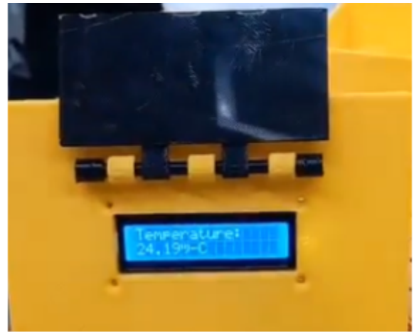
Figure 7 : écran du CUB en train d'afficher la température
