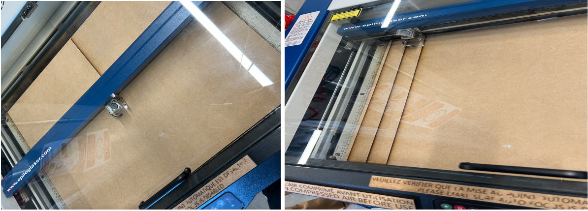
Figure 7 et 8: Découpe au laser de la surface de la table
