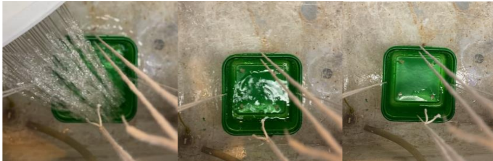
Figure 9. test d'accumulation d'eau
