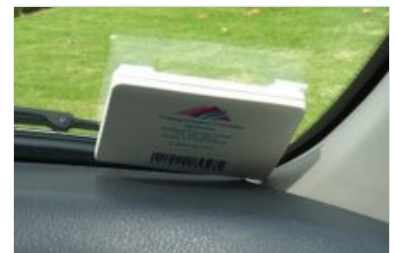
FasTrak, une étiquette RFID utilisée pour le télépéage en Californie.
