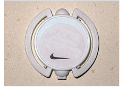
Puce de radio-identification à fixer sur une chaussure.
