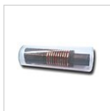
Puce RFID encapsulée, de 5 cm (125 kHz).
