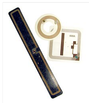
Étiquettes RFID utilisées dans les bibliothèques : étiquette carrée pour livres, étiquette ronde pour CD/DVD et étiquette rectangulaire VHS
