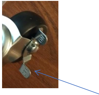
Figure 17 : Description visuelle du mécanisme d'arrêt des roues
