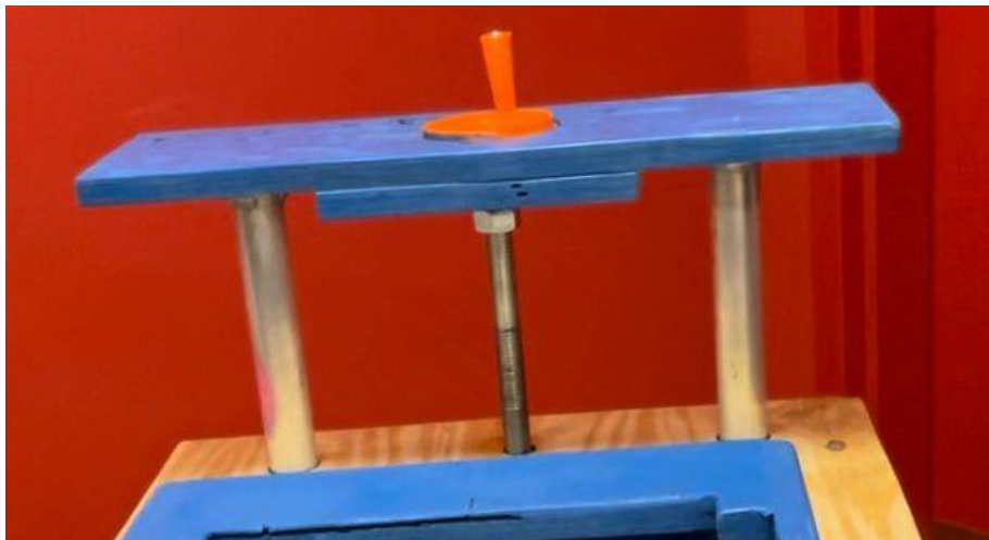
Figure 10. Manivelle utilisée pour l'élévation du dispositif
