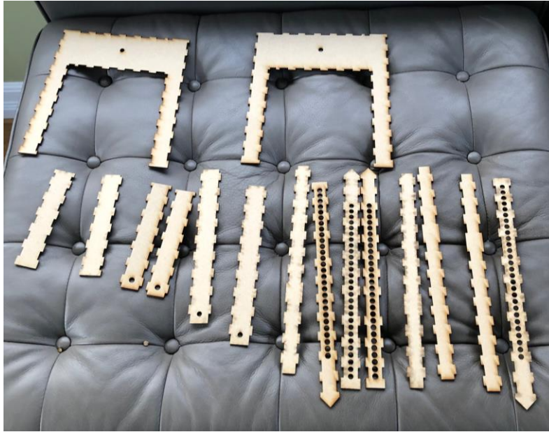
Figure 2: Les pièces du prototype 3, découpé dans du MDF par découpage laser
