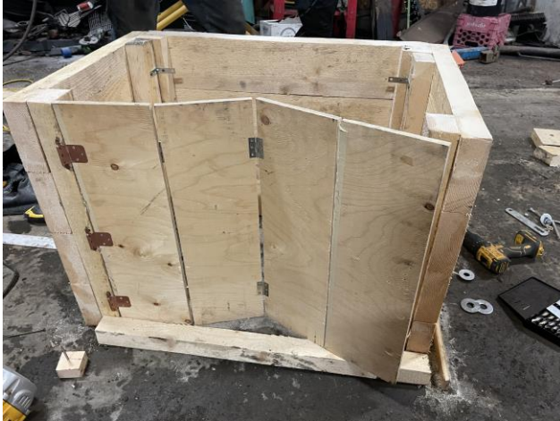
Figure 23. Vue de la porte avec les charnières sur les panneaux et les charnières de porte
