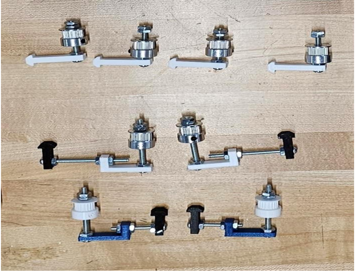
Figure 6.1 : Assemblage final des supports à roues
