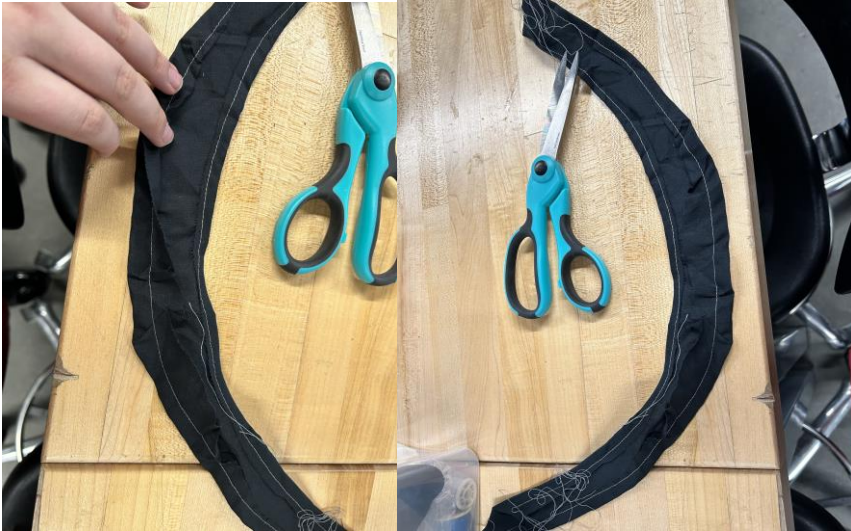
Figure 30 : différents types de couture essayer soit une épaisseur (gauche) ou deux (droite)
