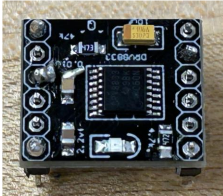
Figure 20 : Contrôleur de moteur soudé à des pattes
