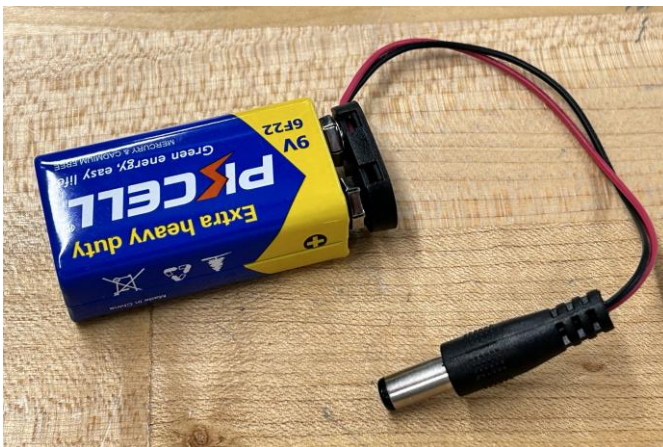
Figure 11 : Adaptateur à batterie avec batterie (9V)
