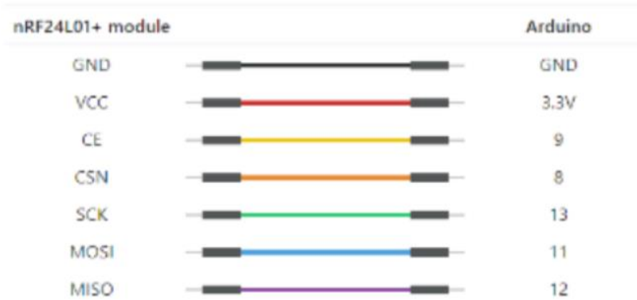
Figure 23 : Branchement ARDUINO-système RF
