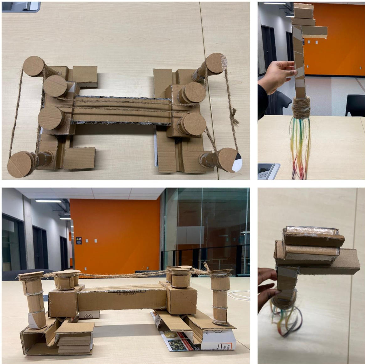
Figure 2.3.1 : Le système de déplacement, le bras mécanique et la brosse pollinisatrice du prototype I
