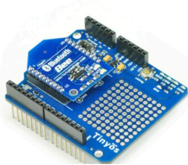
**2-Module Bluetooth :** Le module Bluetooth permet la communication sans fil entre la boîte de pollinisation et l'application sur le téléphone de l'utilisateur, permettant ainsi le contrôle à distance du système.
