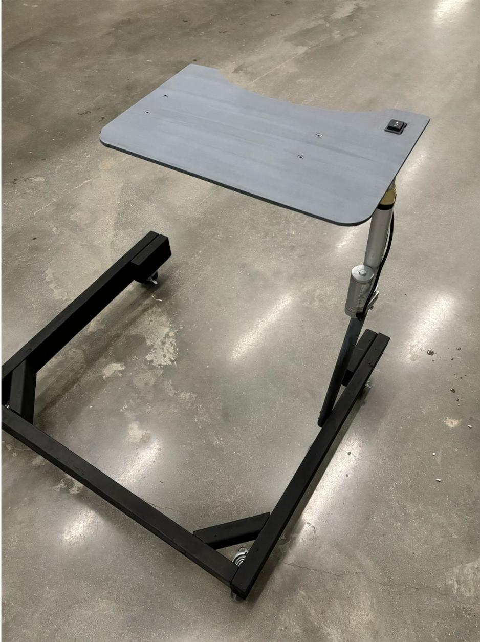
La table ajustable est équipée d'un système permettant d'ajuster sa hauteur et de pivoter à 360 degrés pour faciliter son utilisation par une personne en fauteuil roulant. Le mécanisme d'ajustement repose sur un bouton intégré dans une planche en MDF, reliée à un moteur alimenté par une batterie. Ce dispositif est fixé à un socle en bois recyclé, adapté aux dimensions de la chaise, ce qui permet à l'utilisateur ou à une aide-soignante de modifier la hauteur de la table facilement.
